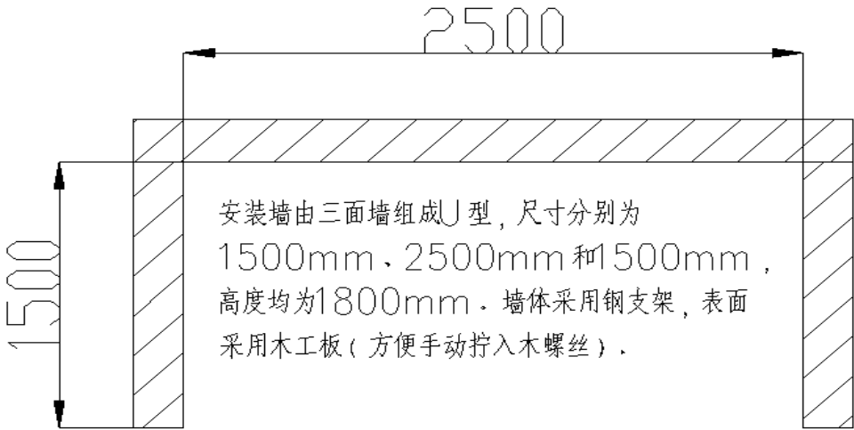
图 4 U 型安装墙面示意图
